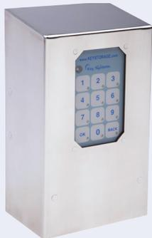
El teclado se basa en capacitancia y no tiene piezas móviles. Es resistente a la intemperie y no tiene membrana móvil ni interruptores mecánicos que puedan desgastarse. La unidad se completa con una liberación de emergencia y se puede montar con dos receptores roscados en la parte posterior que se ajustan con pernos desde el interior del área protegida. SurfaceSWAT™ también es compatible con la tecnología SOC.
